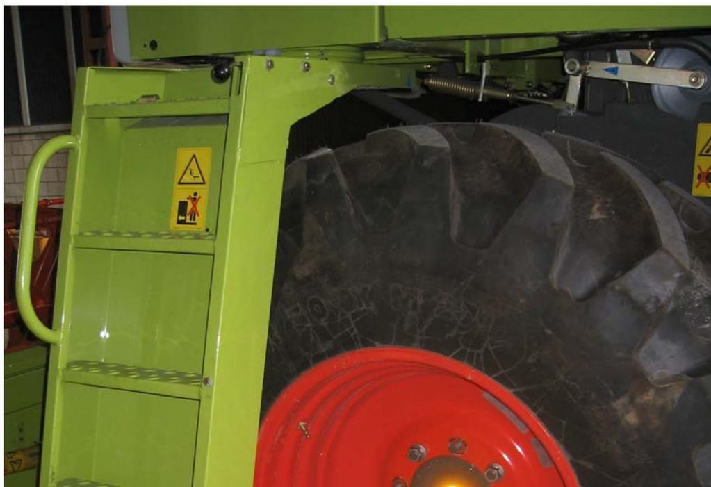
Los puntos de acceso a la maquinaria deben mantenerse limpios y en buen estado de conservación, para evitar riesgos de resbalones y caídas.
