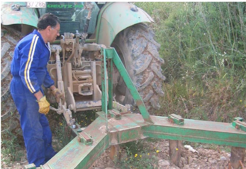
*Cuidado con los procesos de enganche y acoplamiento de la máquinas, pues existe riesgo de atrapamiento.*
