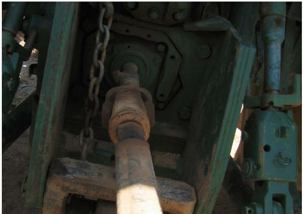
El eje de la toma de fuerza del tractor se conecta al eje de entrada de fuerza de la máquina a accionar mediante un árbol universal telescópico con doble junta cardan. Para ello, ha de tenerse en cuenta que el enganche se efectúe lo más centrado posible.
