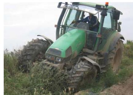
La configuración irregular del terreno es una causa del vuelco lateral.
