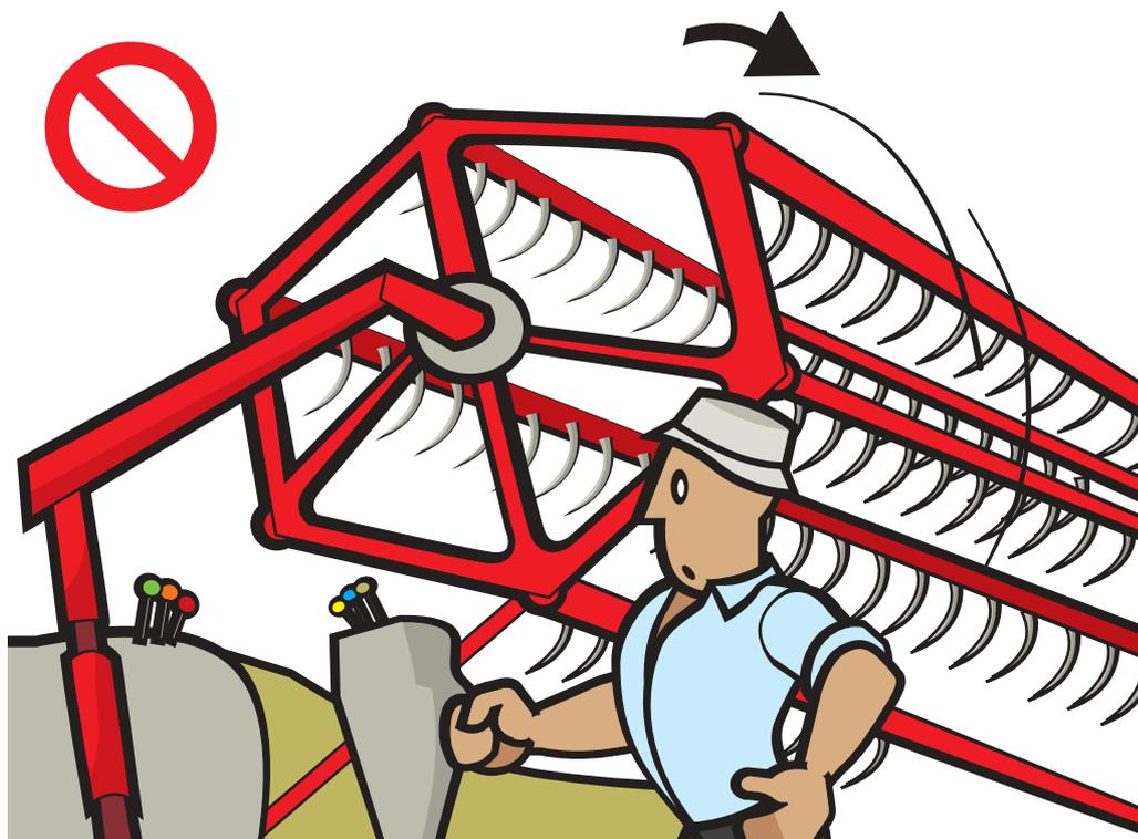
Cuando se levante el molinete para efectuar alguna inspección o ajuste, ha de asegurarse el elevador hidráulico con un tope de seguridad que lo mantenga firme en la posición elevada, para que no pueda caer sobre el operador.
