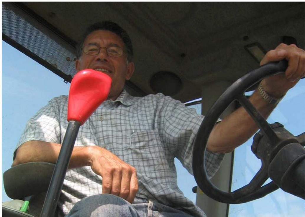
*Ajustar siempre el asiento para evitar dolencias de espalda, y comprobar que la palanca y el volante son accesibles sin esfuerzo.*
