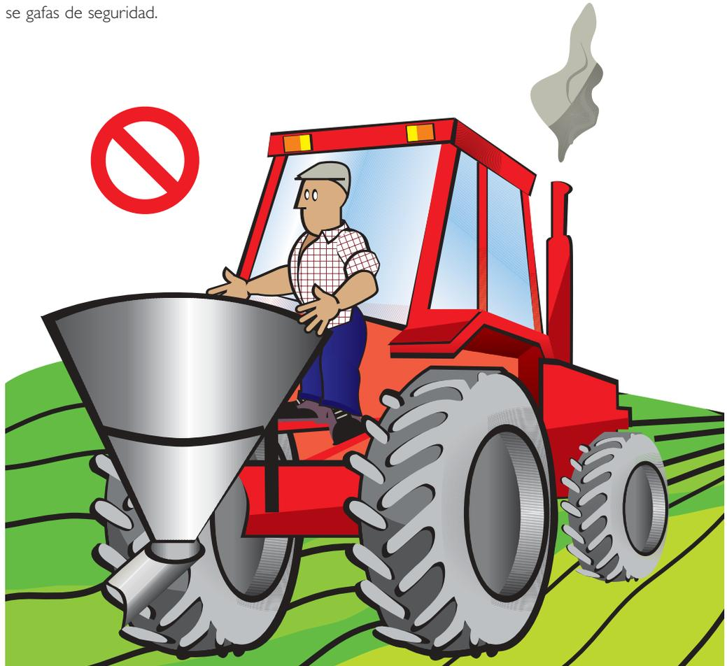
No se debe regular la dosificación del abono con la máquina en marcha, ya que pueden producirse atrampamientos imprevistos.
